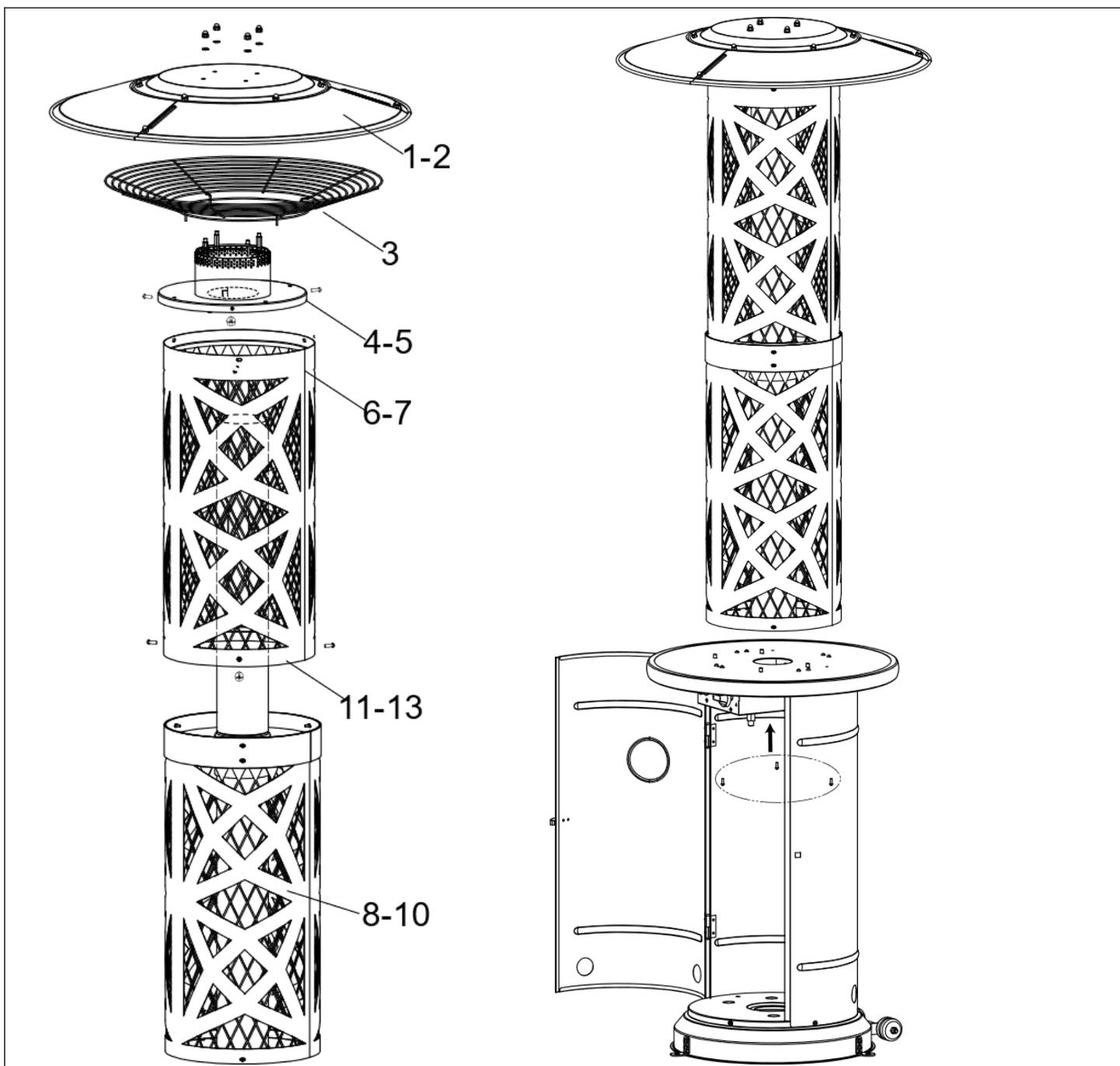
**Passo N°7:** Posizionare in ordine il coperchio decorativo (6-7), la schermatura per la di fiamma con supporti (4-5), la griglia di protezione (3) e fissare queste parti con 6 viti M4x12 (GG).
