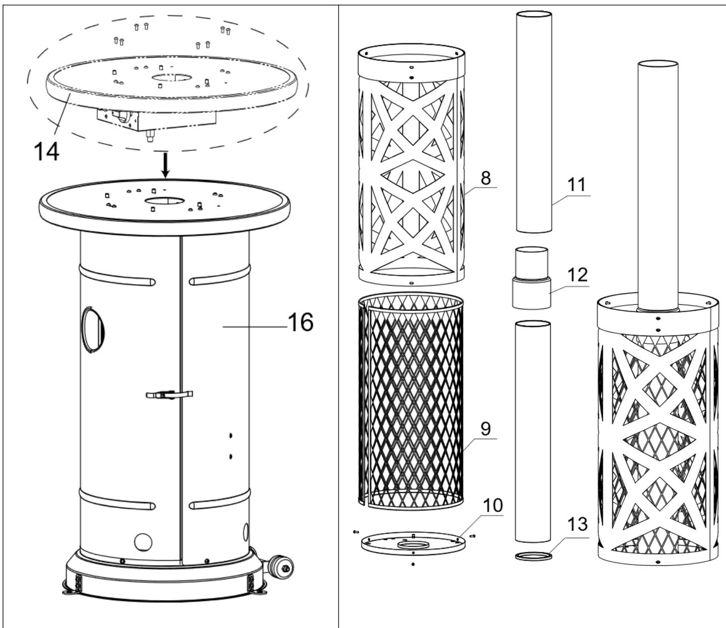
**Passo N°3:** Fissare il piano tondo (14) sull'alloggiamento della bombola (16) utilizzando 8 viti M5x12 (FF).
