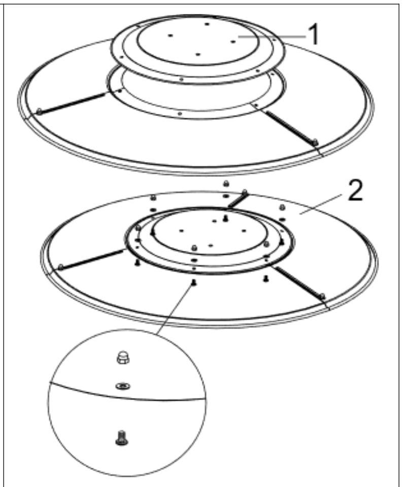
**Passo N°5:** Fissare la piastra del riflettore (2) con 3 viti M6 x 8 mm (BB), rondelle  $\Phi 6$  (CC) e dadi a fondo cieco (AA). Stringere leggermente i dadi a fondo cieco.
