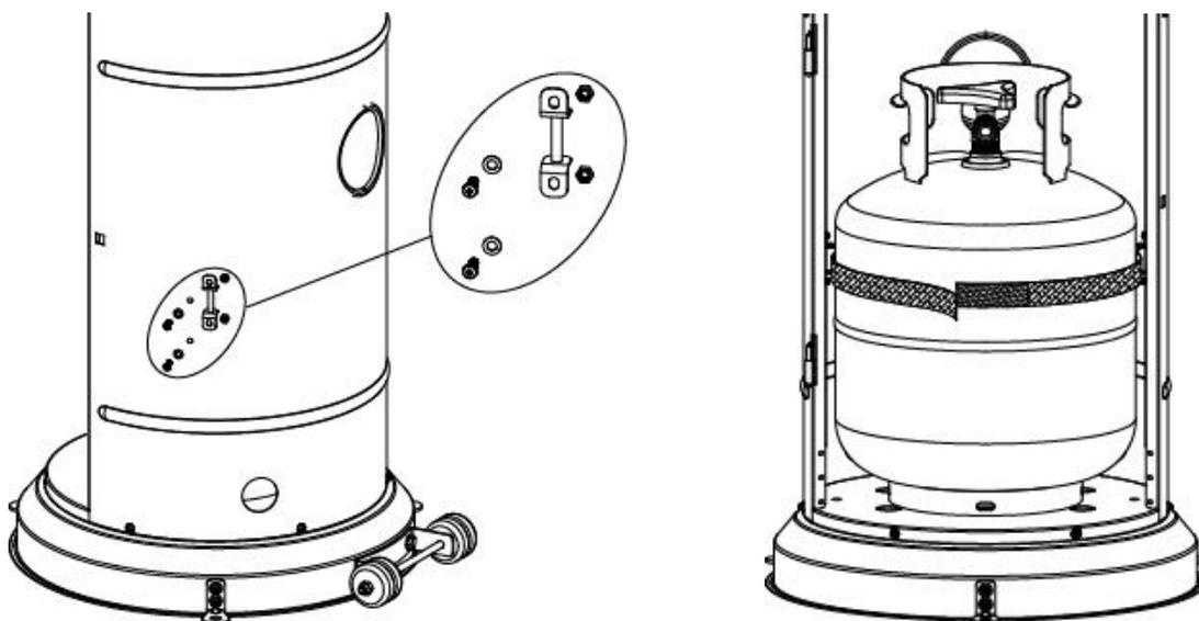
1. Fissare entrambi i nastri in velcro sul retro dell'alloggiamento della bombola utilizzando 4 viti M5\*12 preassemblate, rondelle  $\Phi 5$  e dadi M5.
