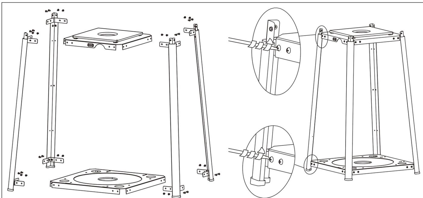
**Passo n°1:** Collegare e fissare le 4 barre di supporto inferiori (1) al pannello base (14) e alla copertura del bruciatore (8) con 32 viti M5 e rondelle (BB).
