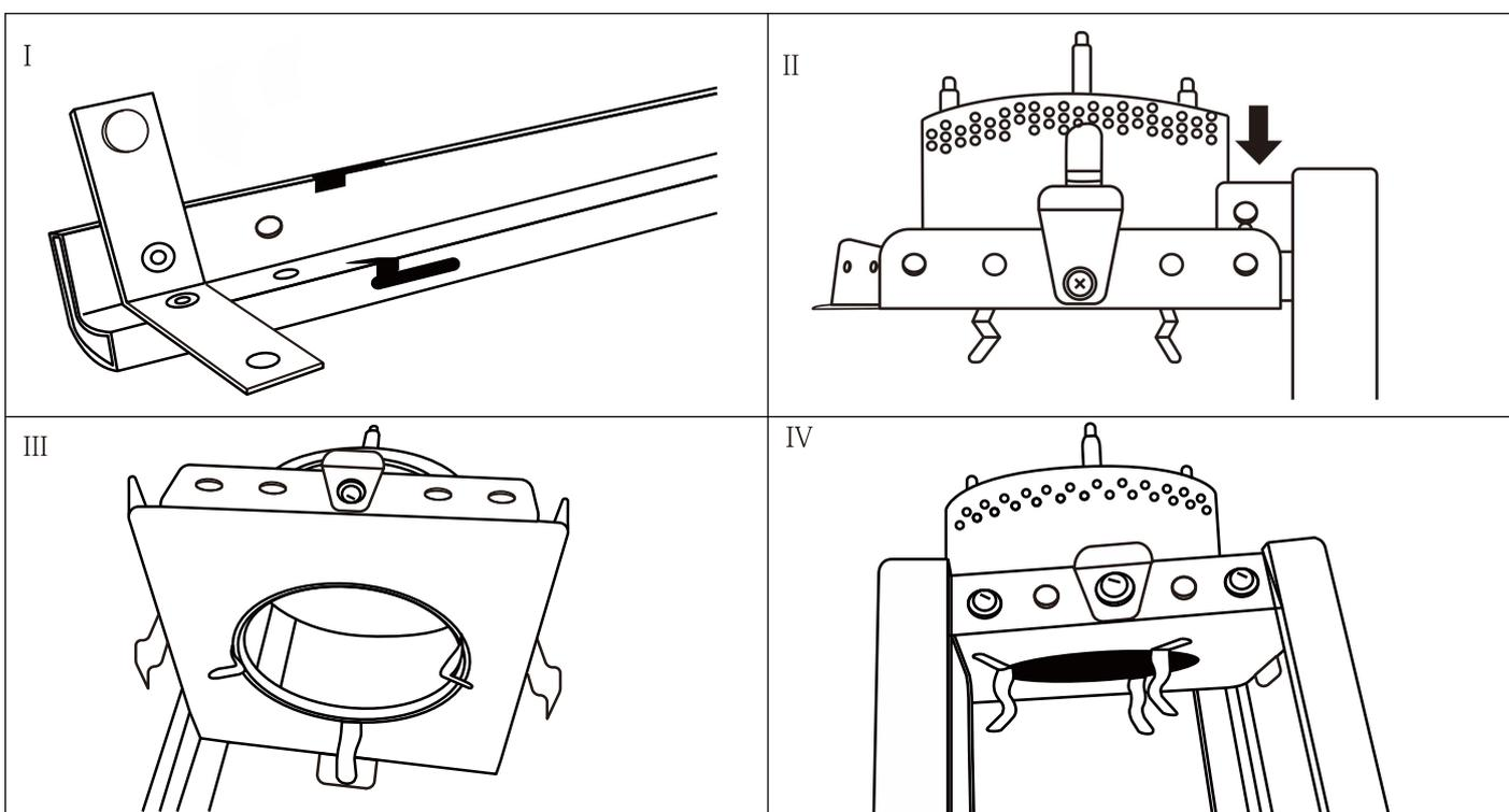
**Passo n°5:** Fissare lo schermo antifiama (2) alla parte superiore della barra di supporto superiore (3) e fissare il collegamento con 2 viti M5 e rondelle (BB), (vedere Figura I , II).
