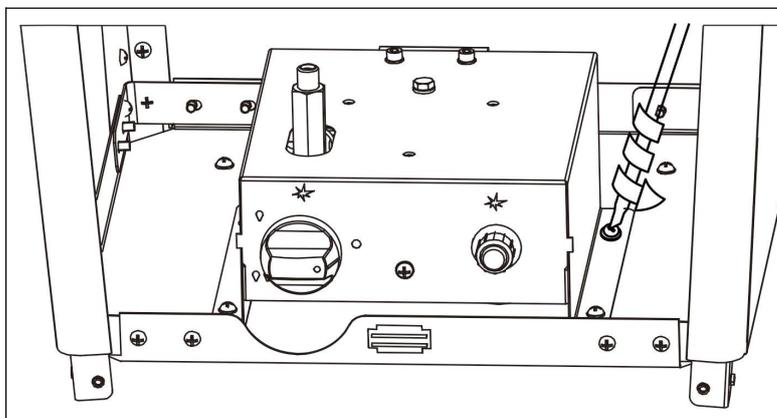
**Passo n°2:** Appoggiare l'alloggiamento della bombola, fissare il gruppo bruciatore (9) alla copertura del bruciatore (8) con 4 viti M5 e rondelle (BB).
