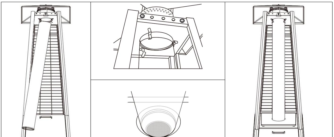
superiore del tubo di vetro nel foro inferiore del parafiamma (2). Mantenere il tubo di vetro in verticale e posizionarlo nel foro della copertura del bruciatore (8).
