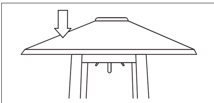
**Passo n°6:** Posizionare il riflettore (1) sullo schermo antifiama (2) e fissare il collegamento con 4 dadi M5 (AA).
