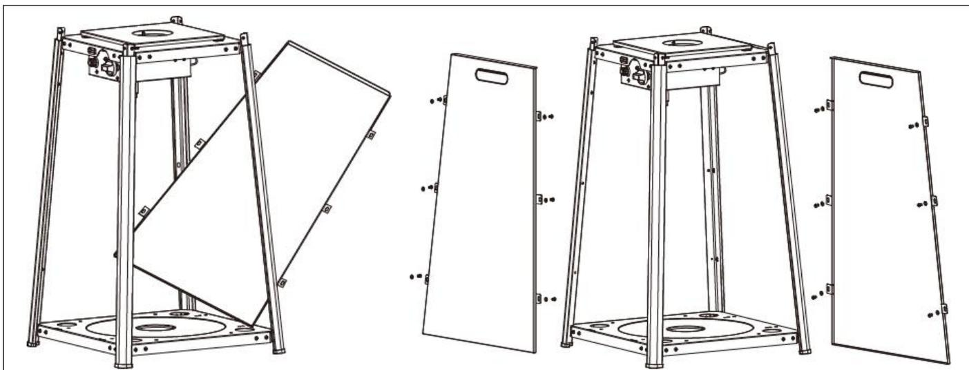
**Passo n°3:** Inserire e fissare obliquamente i 2 pannelli laterali (12) ed il di pannello posteriore (10) nell'alloggiamento della bombola utilizzando 18 pezzi di viti autofilettanti M5 e rondelle (CC). Fissare prima i due lati opposti, fissando le viti in diagonale.
